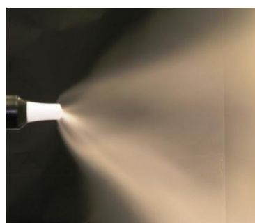
Volumen total de aire insuficiente
