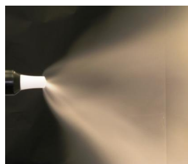
Volumen total de aire insuficiente
