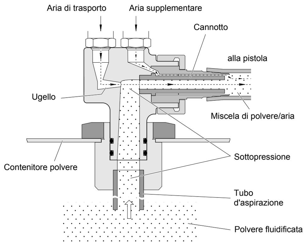
La concentrazione e la portata totale della polvere dipendono dal volume dell'aria di trasporto e di dosaggio, dalle caratteristiche della polvere, dalla lunghezza e dal diametro del tubo della polvere e dalle sue curve, dalla differenza di altezza fra la pistola e l'iniettore e dal tipo di ugello. Anche le condizioni del cannotto dell'iniettore sono di grande importanza. Si è constatato, che quando il cannotto è consumato, la portata di polvere diminuisce notevolmente.
