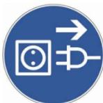
Vor dem Öffnen der Geräte zwecks Wartung oder Reparatur müssen sie stromlos gemacht werden!
