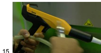
16. Zerstäuber entfernen, reinigen und Pistole durchblasen
