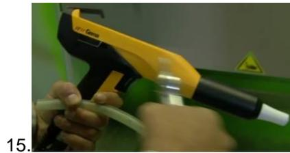
16. Zerstäuber entfernen, reinigen und Pistole durchblasen
